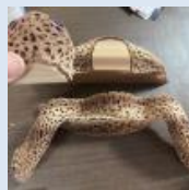
3Dプリンタで型枠作成
