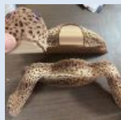
3Dプリンタで型枠作成
